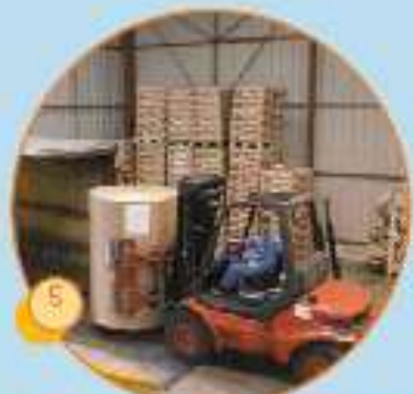
Utilisation d'un chariot automatique à conducteur porté pour décharger des boîtes de papier
